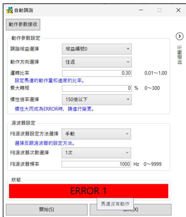
圖 3-6 自動調諧時的錯誤畫面例
