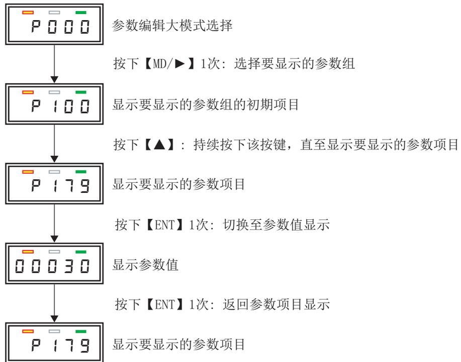
图10-5 P179的数据显示操作例
