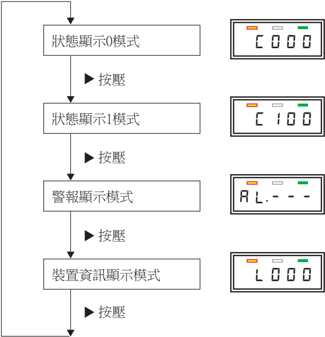
圖10-1 狀態顯示模式的構成和轉變
