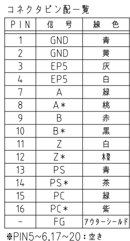
ミットヨ製電磁誘導式ABSエンコーダ ST708A仕様
