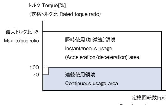
※ 最大トルク比はモータタイプにより異なります。(最大トルク/定格トルク)
