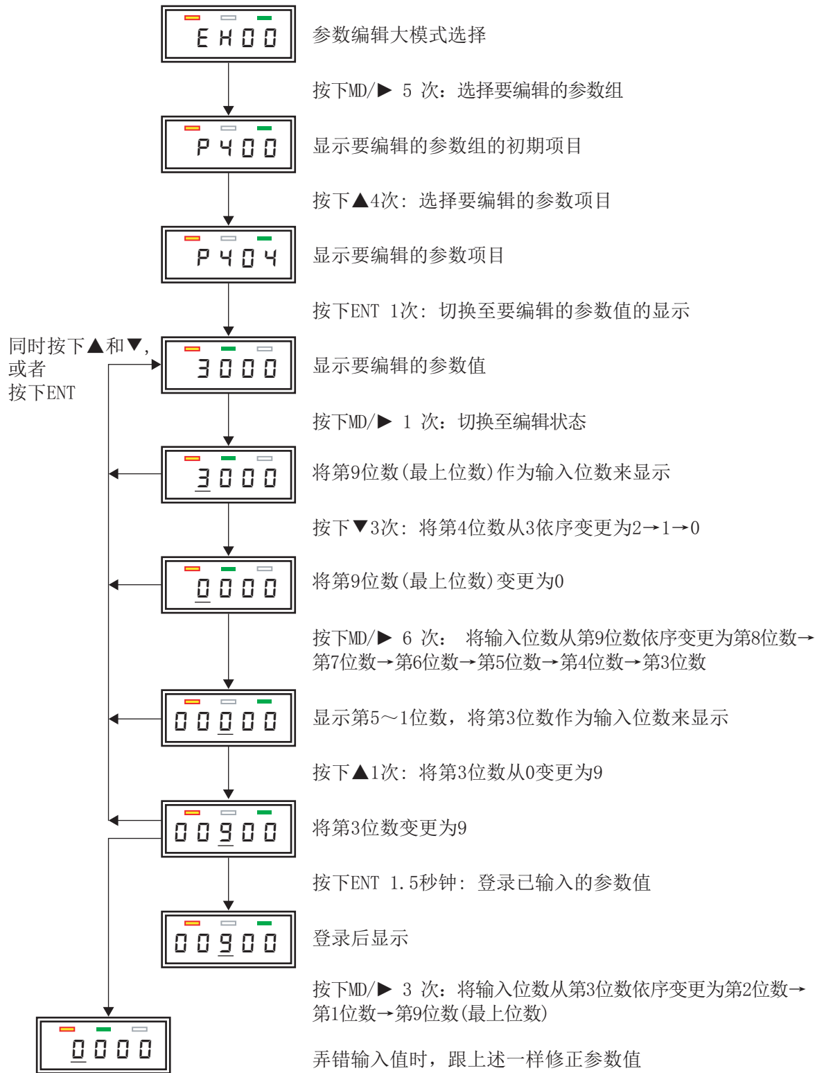
图12-7 P404参数值(最大9位数)：从300000000变更为900的示例
