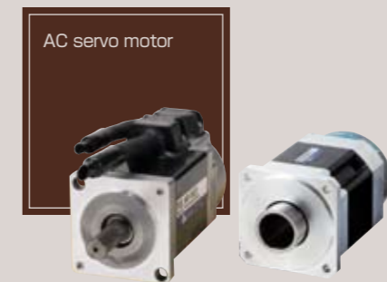
AC servo motor Synchronous type 50W~ 29kW/2000rpm~3000rpm Induction type 1.2kW~55kW/1000rpm~4000rpm
